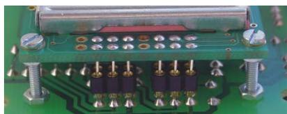
Obr. 3. Vývody displeje
